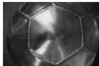
Fig. 1 AZ31 マグネシウム合金製のサッカーボール (ティグ溶接)。
