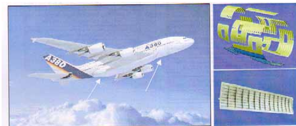
図24 エアバス機のスキンパネルとスティフナーのレーザ溶接パネル[31]
