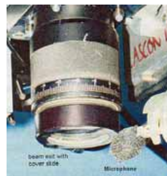
図9 マイクロホンによる音響モニタリング[10]
