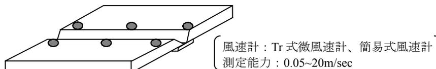
図3 風速測定位置
