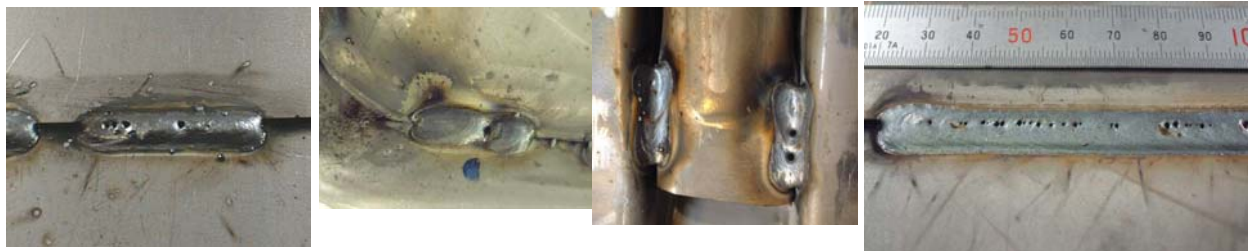
図4 亜鉛蒸気によるピット発生の典型例
