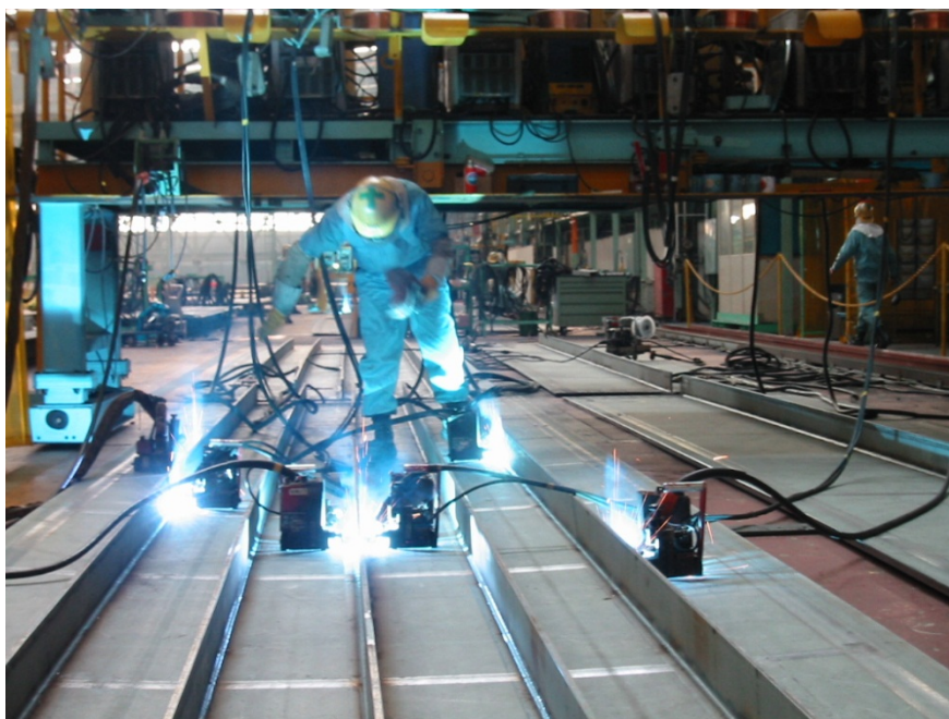
図 1 橋梁パネル溶接（Ar90%-CO 2 10% GMAW）の様子
