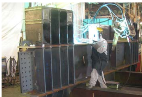
工場における鉄骨製作状況及び現場建方状況
