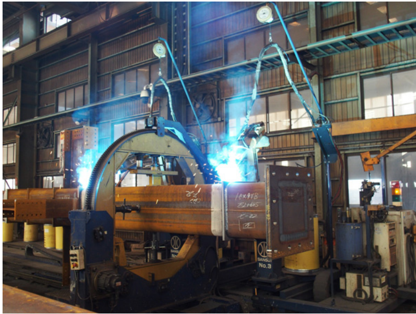
ロボット溶接機を昨年新たに投入 ロボットオペレータにも溶接の知識が必須
