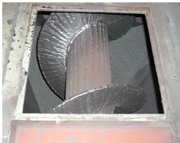
溶接肉盛の実施例：ショットブラスト装置搬送スクリーへの硬化肉盛溶接
