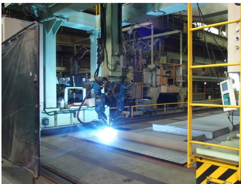
ウェブパネル溶接ロボット
