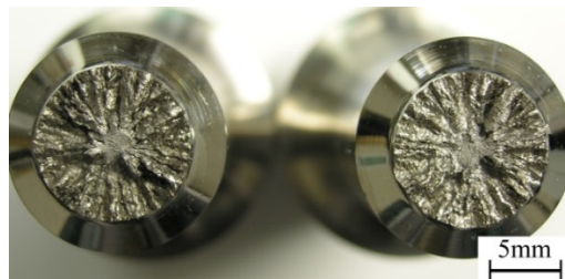
図1 繰返し振り疲労試験における破面の様相 (オーステナイト系ステンレス鋼 SUS316L) (1)
