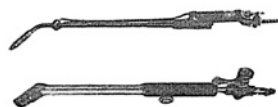
写真2.3 大正初期のフランス式(上)とドイツ式(下)のガス溶接トーチ
