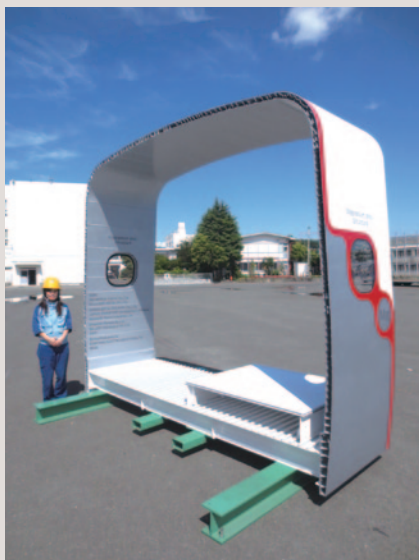
◀ 新エネルギー・産業技術総合開発機構 (NEDO) と新構造材料技術研究組合 (ISMA) が難燃性マグネシウム合金を用いた世界最大級の高速鉄道車両部分構体の試作に成功
