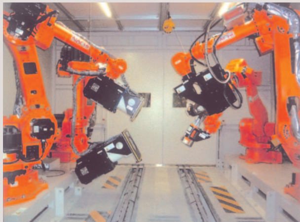
▼ 2組の高輝度X線を使いリアルタイムで溶接内部の現象を立体的に把握できる透視可視化システム。大阪大学接合科学研究所に導入。同システムの構築は世界初
