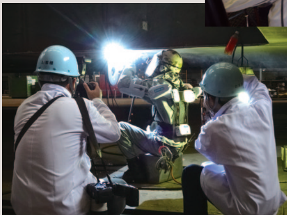
◀造船での上向溶接にパワーアシストスーツ が適用
