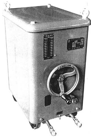
図 4.12 空冷式可動鉄心形交流アーク溶接電源 1)
