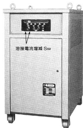
図 4.18 大容量可動鉄心形交流アーク溶接電源
