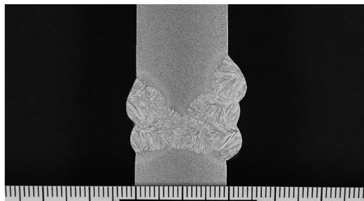
写真4 横向 SAWの断面マクロ組織の一例
