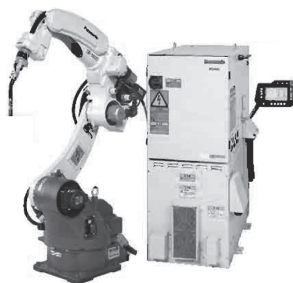
図9 ケーブルの埋め込み化
