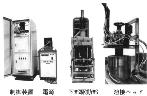
図14 CRD スタブ自動溶接装置
