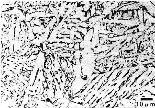
図6 単一溶接熱サイクルを受けた場合の組織例 入熱 40 kJ/cm, 予熱・パス間温度 350℃
