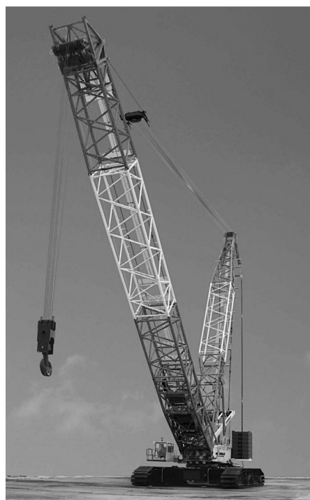
図3 クローラクレーン（最大つり上げ荷重 500 t） （写真提供：日立住友重機械建機クレーン(株)）
