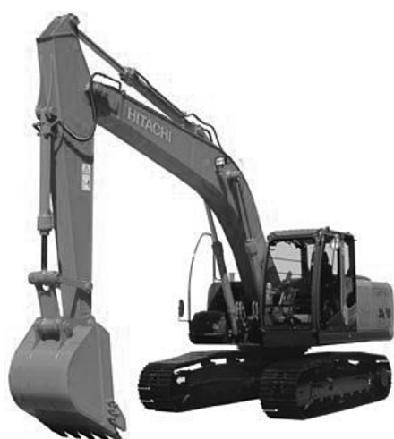
図2 油圧ショベル（機械質量 20 t）
