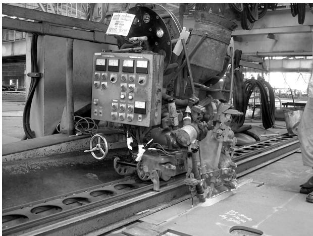
図10 サブマージアーク溶接装置
