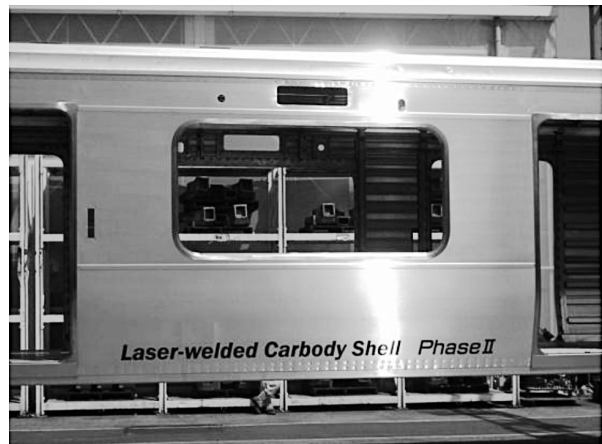
図19 試作構体の側外板面の仕上り
