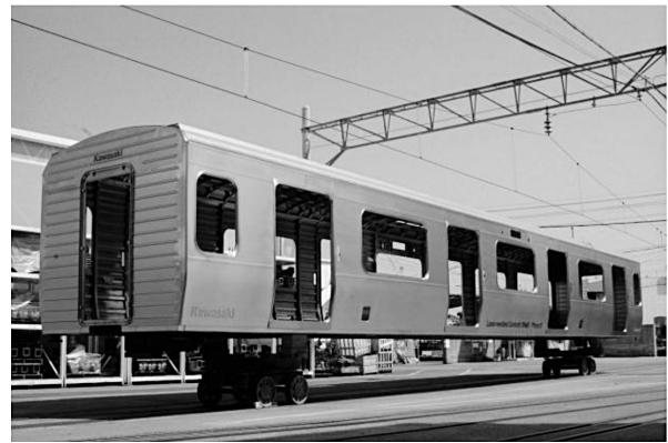
図18 レーザ溶接による試作構体
