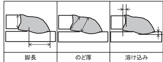
図15 ビードの断面寸法
