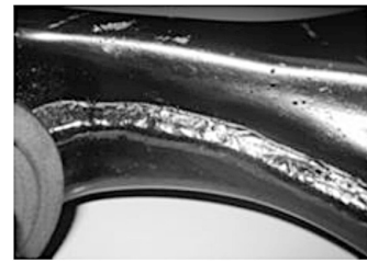
図14 アーク溶接適用部品例 (FR ロアアーム)
