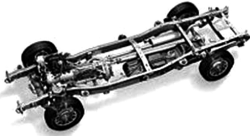
図2 フレーム形式の例（ラダーフレーム）
