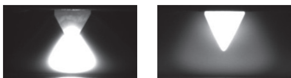
(a) 地球大気 (b) 擬似火星大気 (1000 Pa) 図1 アーク外觀の比較 (直流GTA)
