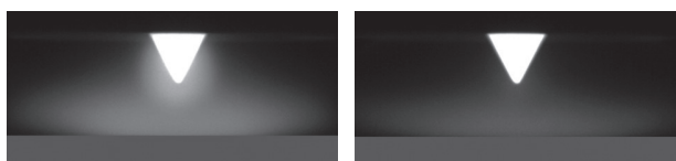
(a) 電極マイナス (EN) (b) 電極プラス (EP) 図2 擬似火星大気中の交流GTA (1000 Pa)
