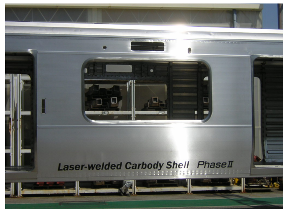
図 19 試作構体の側外板面の仕上がり (側構体全面に適用)
