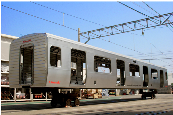
図 18 レーザ溶接による試作構体
