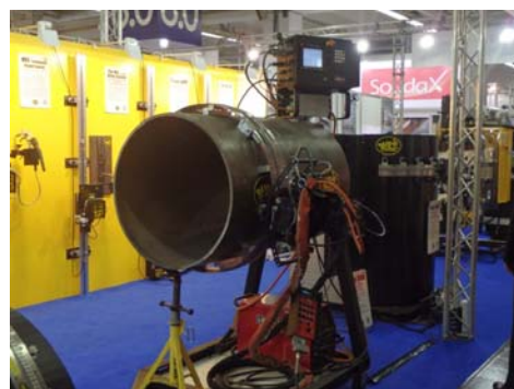
図 3: パイプ自動円周溶接機
