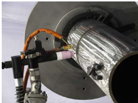
図15:パイプ円周溶接用高能率TIG施工法
