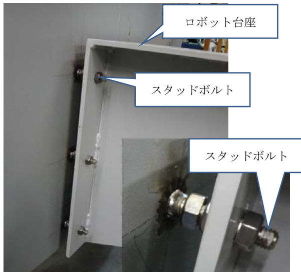
図 2.4 ロボット台座固定方法
