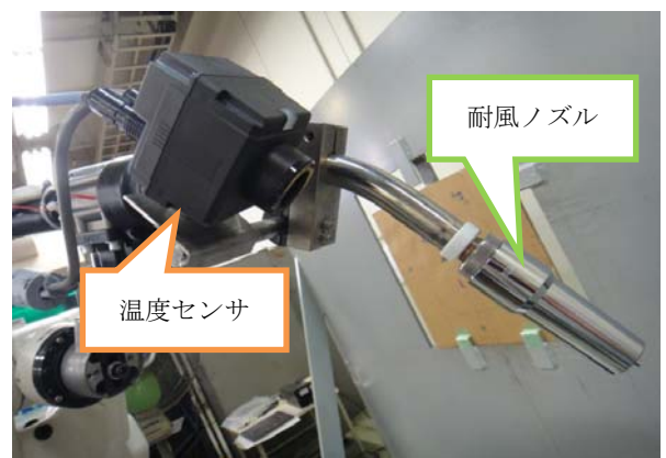
図 2.3 耐風トーチおよび温度センサ
