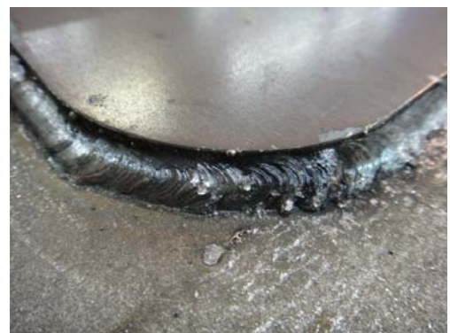
図 3.4 従来手法による溶接ビード外観 (アールあり)
