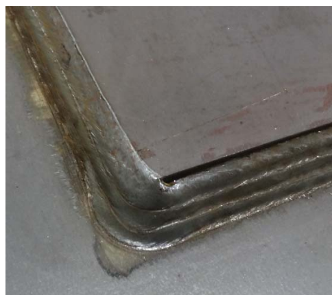
図 3.3 開発手法による溶接ビード外観
