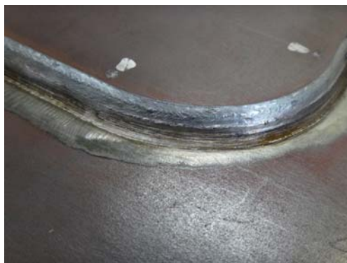
図 3.3 開発手法による溶接ビード外観
