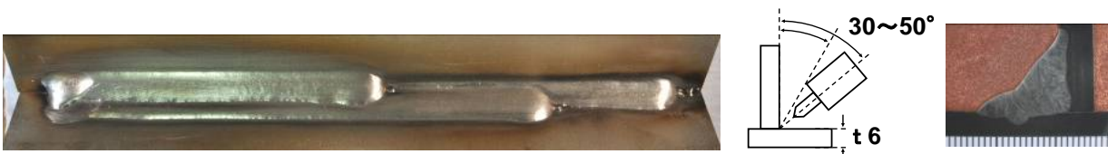
図 15 T 字隅肉継手の多パス溶接における適用例 [SUS304 t6mm 溶接速度 30cm/min シールドガス : Ar 3 パス]
