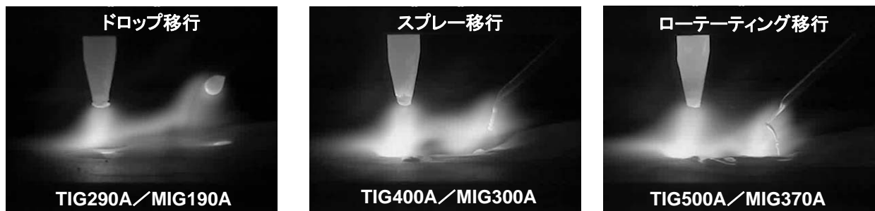
図 8 各 MIG 溶接電流における溶滴移行形態の変化(t12mm SUS304 ビードオン)
