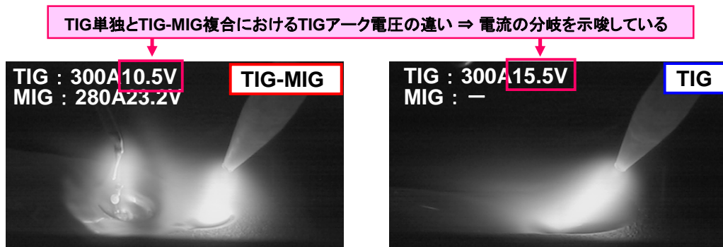
図 13 実験結果における TIG-MIG 複合アークと TIG 単独アークの TIG アーク電圧比較
