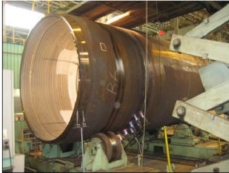
図7 シェル周溶接施工の様子
