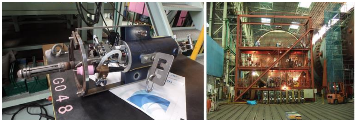
(a) 可搬式自動ティグ溶接装置
