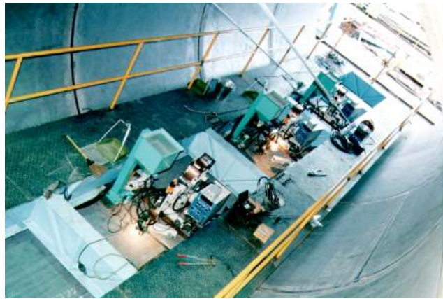
図 8 4 シーム同時溶接装置
