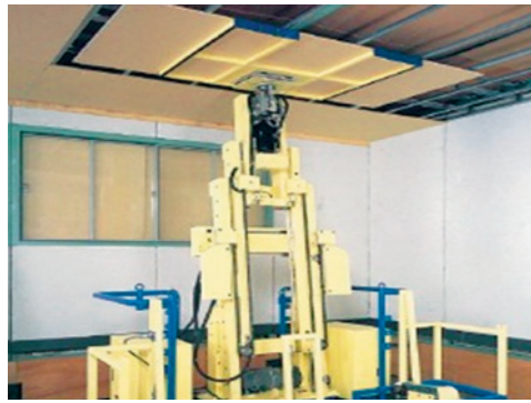
図7 天井ボード貼ロボット
