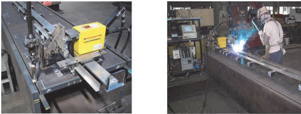
図2 可搬型溶接ロボットによる J-STAR ® 溶接
