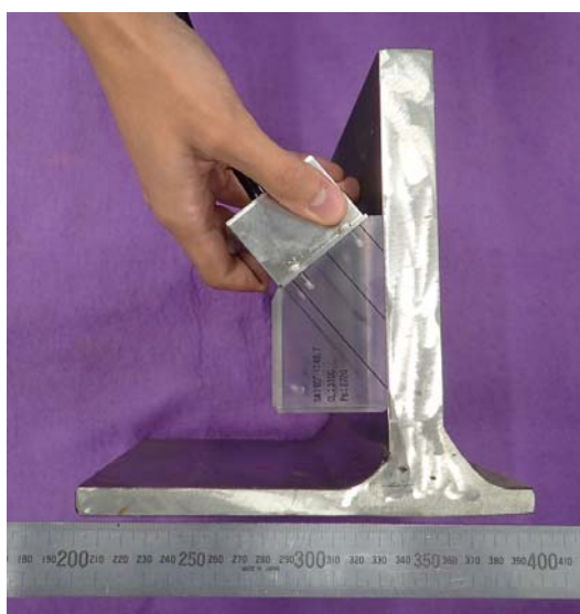
図 5 供試体と探傷位置
