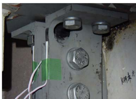
図 12 熱弾性応力測定による当て板補修効果の検証結果
