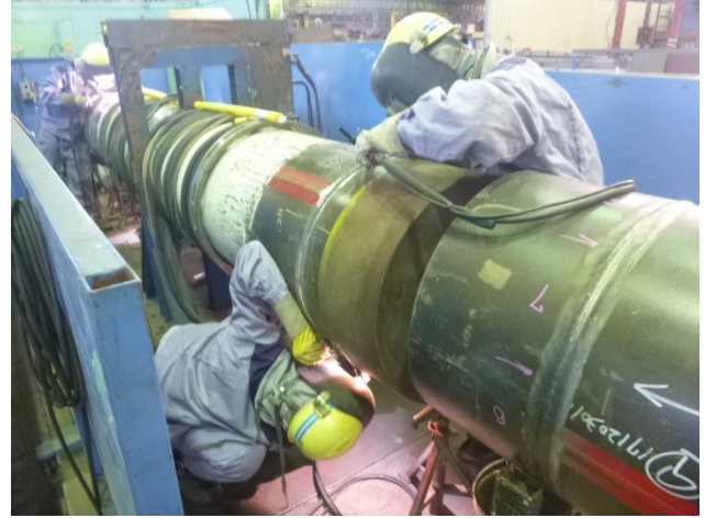
図 9 溶接施工法確認試験（ティグ補修溶接）
