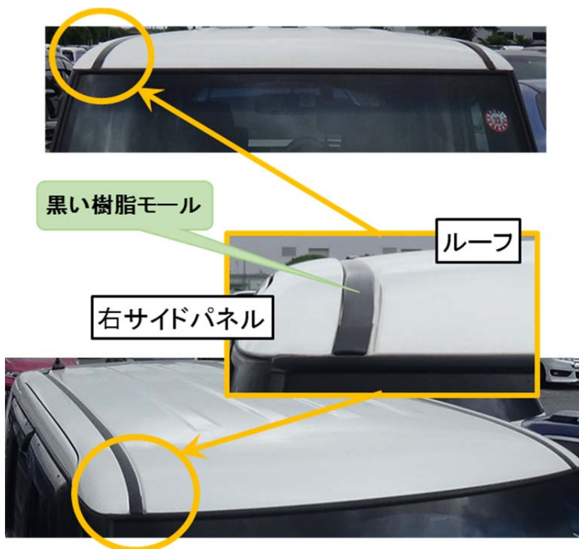
図 1 樹脂モールのルーフ外観
