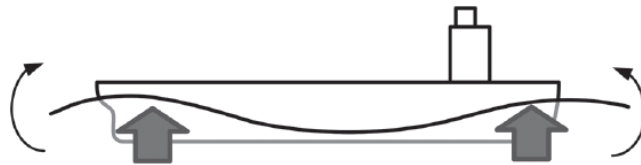
(b) サギング (船体が凹形状に曲げられる状態)
