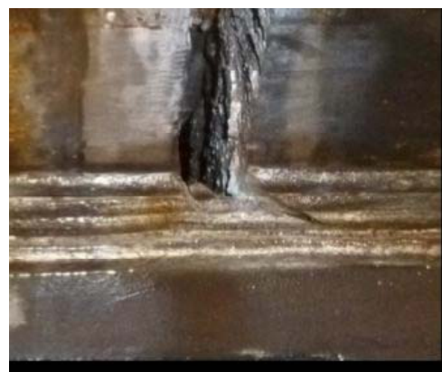
(b) すみ肉溶接へのぜい性亀裂の突入部
