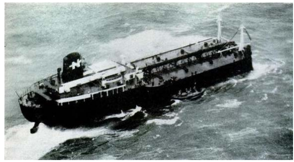
図2 航海中に船体が真二つに折損した World Concord 号 4)
