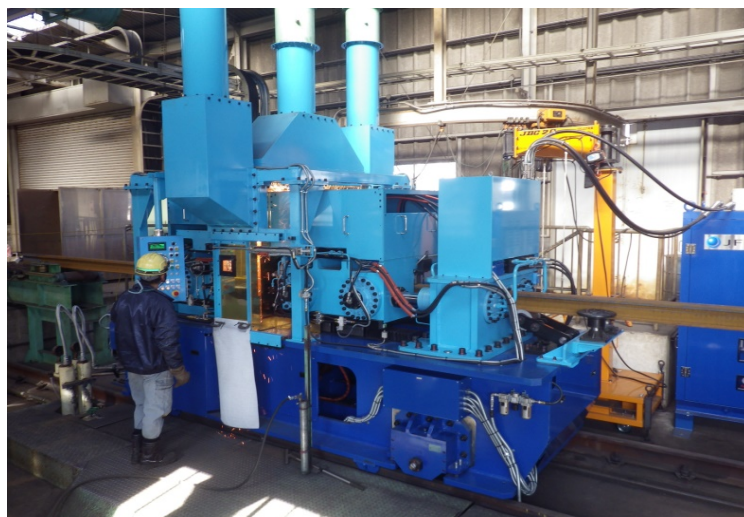
定置型FW機（JR東納入）。「これまでの交流方式からインバータ直流方式とした初のFW溶接機である」
