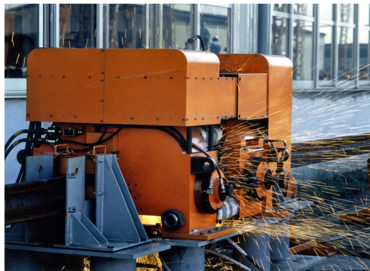
可搬型レール FW 機。「日本製では初の現地施工用可搬型 FW 機である。現時点でも日本製レール FW は当社のみ」
