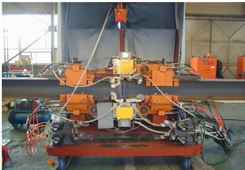
H形鋼FW機（対象：700×300H 接合断面積 20,000mm 2 ）。 「山留用700×300HをFWで接合できる一体型の溶接機を設計すると 重量が約20tonとなる。現地適用のため分離型のFW機を設計製作し、 重量が1/10の2tonの溶接機を開発した」
