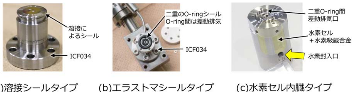
図 4 水素透過実験用試料ホルダー各種
