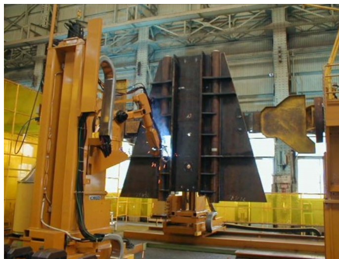
導入時に今倉氏が技術を担当したディーゼルエンジン構造部品の最新型溶接ロボットシステム
