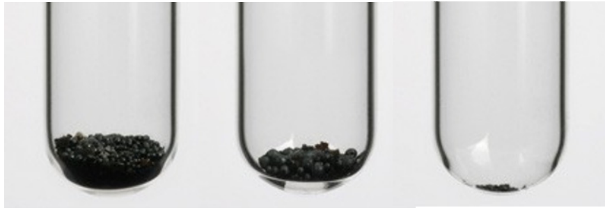
図4 スパッタ発生量比較 (左からショートアーク: 0.376g、パルス: 0.264g、CMT: 0.002g)
