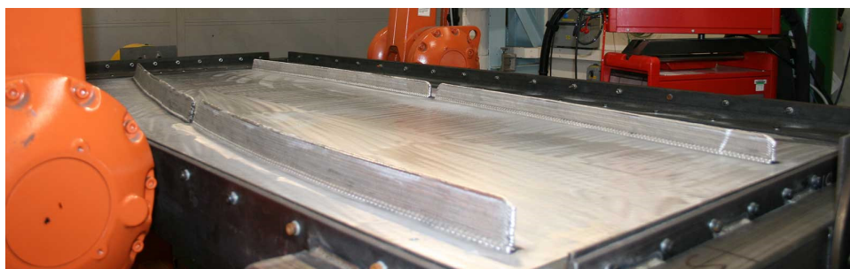
図 11 WAAM 方式による造形例 (基材 : Al 2219, ワイヤ : Al 2319)
