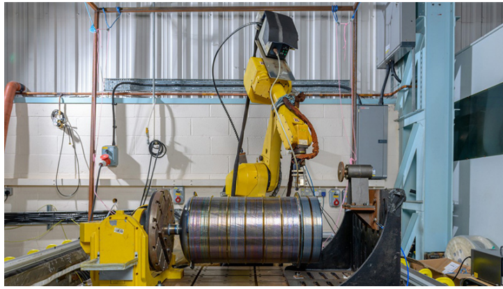
図 8 チタン製圧力容器の造形時の状態
