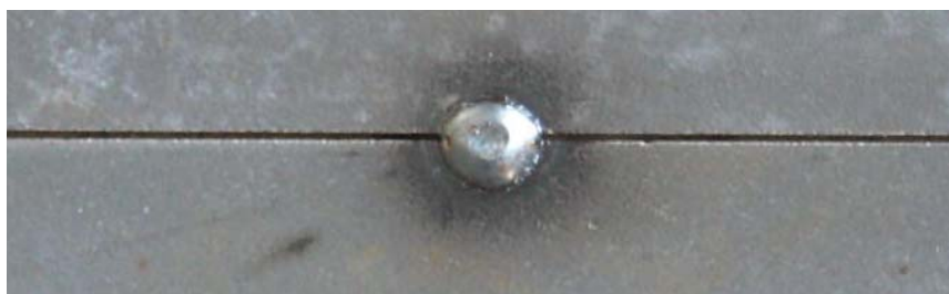
図 5 仮付け部外観
