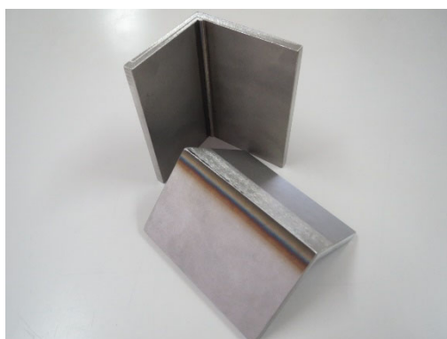
図5 プラズマ溶接で製作した溶接山形鋼
