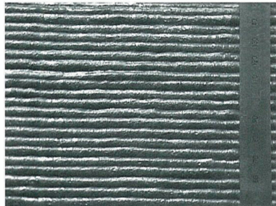
図5 オーバーレイ溶接ビード外観 (FCAW)
