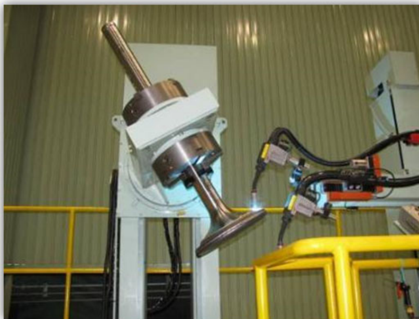
図 3 排気弁自動溶接装置
