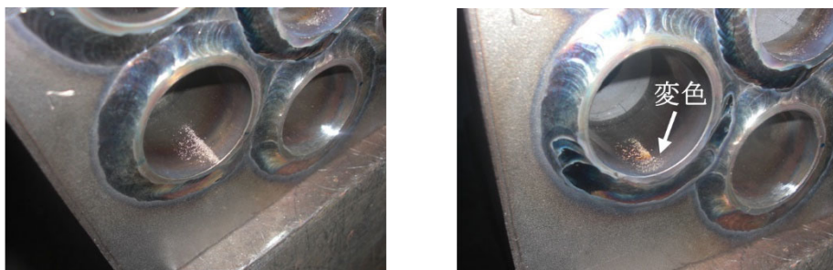
図 7 金属粉をチューブ内面に置いて溶接を行った状況
