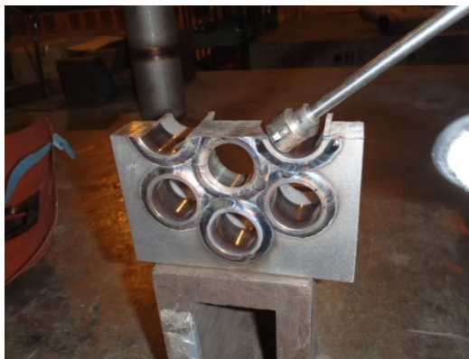
図 9 ストレンクス溶接時のチューブ内表面温度計測の状況
