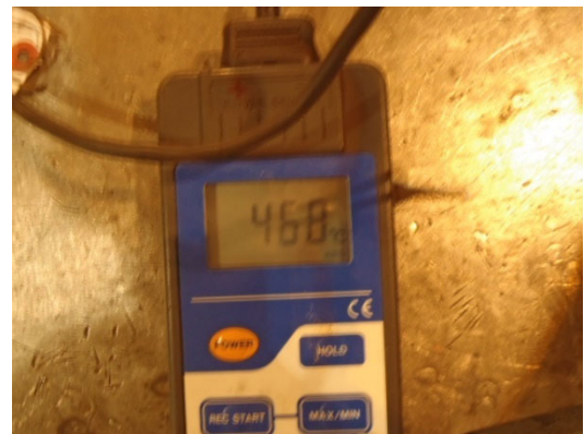
図 9 ストレンクス溶接時のチューブ内表面温度計測の状況
