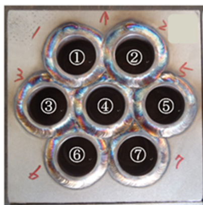
図 2 溶接後のモックアップテストピース外観
