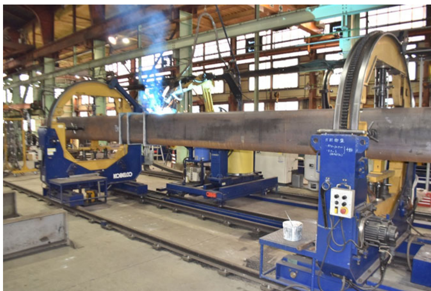
天吊柱大組溶接ロボット
