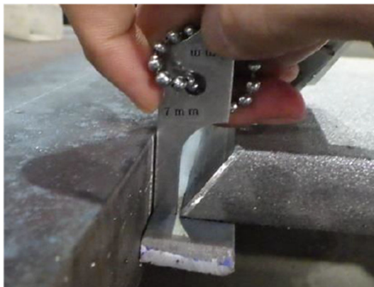
図5 開先検査状況
