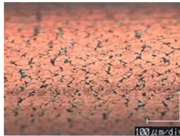
ワイヤ表面写真(亀甲パターン) 亀甲パターンの溝が潤滑剤をしっかりと保持
