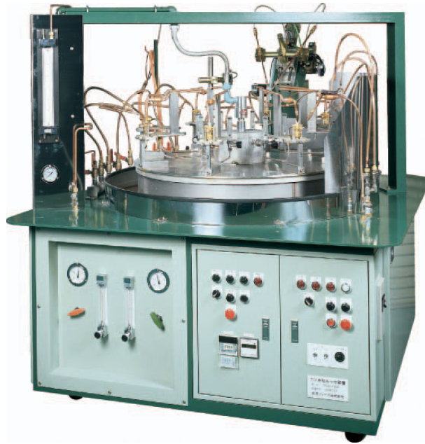
図2 回転テーブル式自動トーチろう付機
