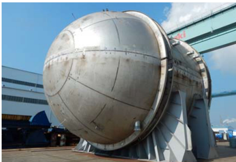
図3 1000m 3 試験タンク外観 1)
